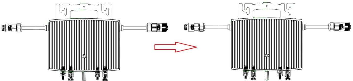
B Befestigen Sie die AC-Endkappe an einem geöffneten AC-Anschluss
