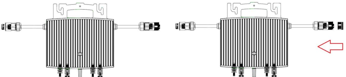
*\* Beachten Sie, dass die Länge des AC-Kabels am Micro Inverter ca. 2 Meter beträgt, wenn der Abstand zwischen den beiden Micro Invertern mehr als 2 Meter beträgt. Verwenden Sie ein AC-Verlängerungskabel zwischen den beiden Micro Invertern, wie in der Abbildung unten gezeigt.*
