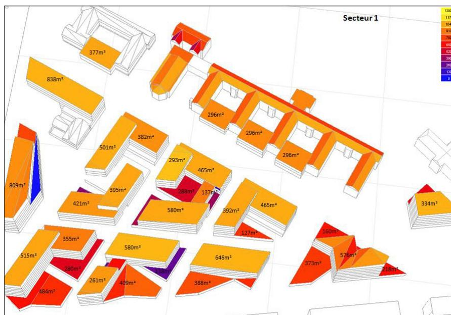
Simulations d'ensoleillement des toitures pour évaluer les surfaces exploitables pour la pose de panneaux solaires photovoltaïques.
