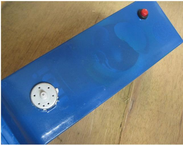
**5.** Den Schalter von außen durch die Öffnung schieben und von innen festschrauben. Den Motor vorsichtig durch die fransige Öffnung schieben, so dass er gut feststeckt.
