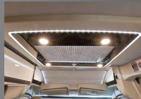
Baldachin mit indirekter Beleuchtung und zusätzlichen LEDs sorgt für optimale Ausleuchtung in der Sitzgruppe.
