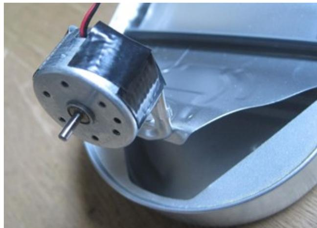
**3.** Die Solarzelle mit Hilfe der beiden Druckklemmen an den Motor anschließen, dann die Kabel in den Bauch der Büchse schieben und die Solarzelle auf dem Deckel platzieren.
