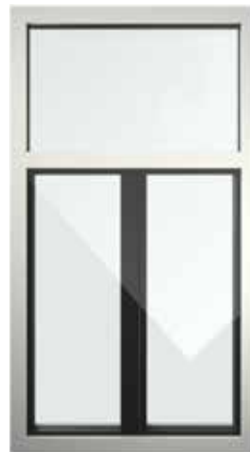
Oberlicht als Festfeld mit zweiflügeligem, rahmenlosem Fenster und glasüberdeckter Mittelpartie (Typ 404)
