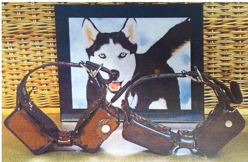
Collier de chien de l'armée suisse avec émetteur, pile et antenne radio
