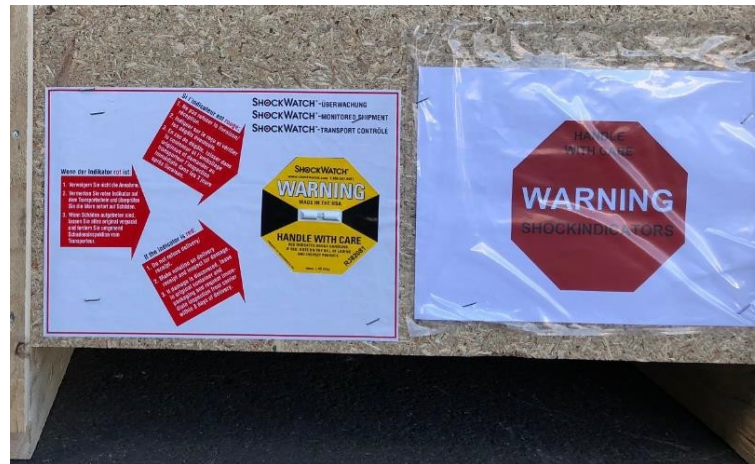
Рисунок 2. Расположение индикатора удара
