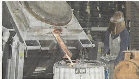
Die zerstörten Teile wurden in einer Berliner Gießerei gegossen und mit den erhaltenen Elementen zusammengesetzt.
