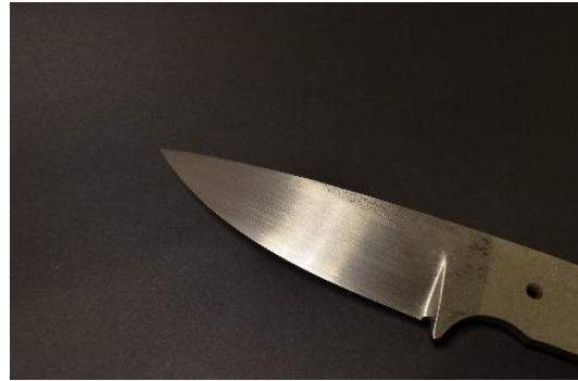
Abbildung 14: Handschleifen der Klinge (Verfasser)
