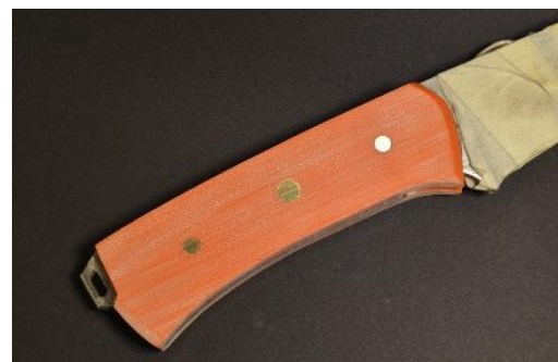
Abbildung 16: Grob geschliffener Griff (Verfasser)
