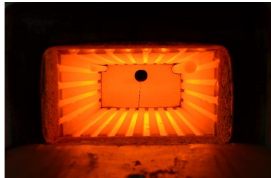
Abbildung 10: Der Härteofen beim Aufheizen auf Härtetemperatur (ca. 980-1000°C) (Verfasser)
