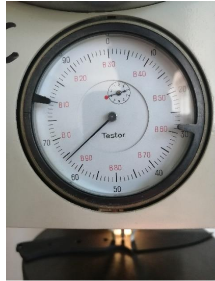
Abbildung 12: Härtewert der Klinge beträgt 64 HRC (Verfasser)
