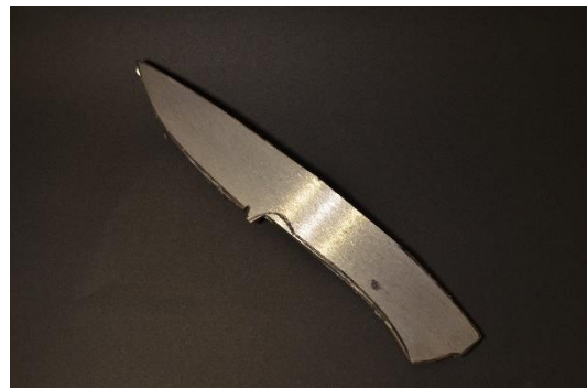
Abbildung 5: Grob ausgeschnittene Klinge (Verfasser)
