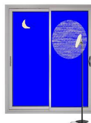
Un éclairage de type halogène à proximité du vitrage ou orienté vers le vitrage.
