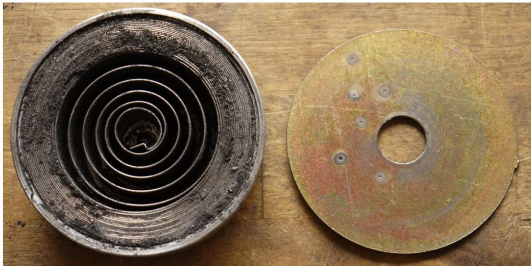
stark, ist wie alle glatt verrundet überschliffen. Der Federkern liegt mit dem rechten Zapfen in einer eingesetzten Lagerscheibe, mit dem linken unmittelbar in der Hauptplatine.
