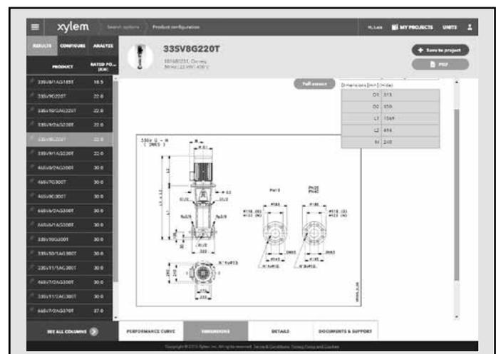
Die Produktmaße sind auf dem Bildschirm sichtbar und können im dxf-Format heruntergeladen werden.
