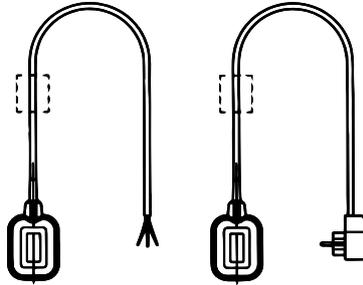
Für Doppelfunktion (Befüllung und Entleerung) Kabellänge 1,5, 5, 10, 20 m Gegengewicht auf Anfrage für 5 und 10 m Länge lieferbar. Für Wechselstrompumpen bis 1 kW mit Doppelstecker lieferbar.
