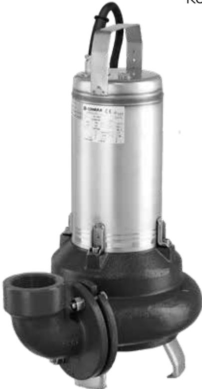
Die Tauchpumpen der Baureihe DL sind sowohl mit Einkanallaufwerk, als auch mit Vortexlaufwerk (DLV) lieferbar. Die Pumpen sind für den Einsatz in grob verschmutztem Wasser und Abwasser konzipiert und erreichen Fördermengen bis zu 42m<sup>3</sup>/h und Förderhöhen bis zu 22 m.
