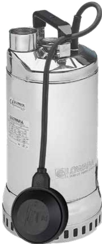
Tauchpumpen für sauberes und leicht verschmutztes Wasser hergestellt aus AISI 304 Edelstahl. Förderhöhe bis 20 Meter, Fördermenge bis zu 420 l/min (25,2 m<sup>3</sup>/h). Vier Grundmodelle mit 0,55 bis 1,5 kW. DRIVELUB Dichtungssystem. Diffusorplatte mit Polyurethan beschichtet für eine maximale Abriebsfestigkeit.
