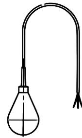
Für Schmutzwasser mit Feststoffen Kabellänge 15 m PVC.
