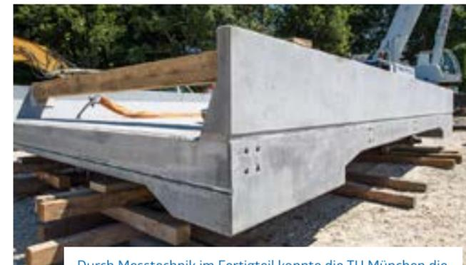
Durch Messtechnik im Fertigteil konnte die TU München die tatsächlichen Verluste der Vorspannung sowie die Entwicklung der Hydratationswärme im realen Bauteil prüfen.
