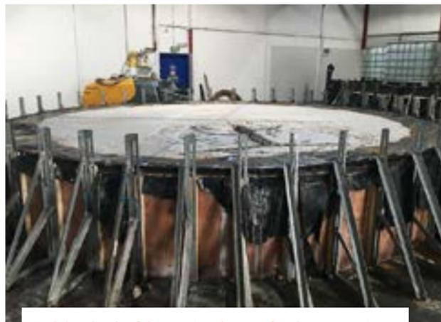
In Schottland erfolgte an Land ein maßstabsgetreuer Versuch der Verfüllung eines Podests.
