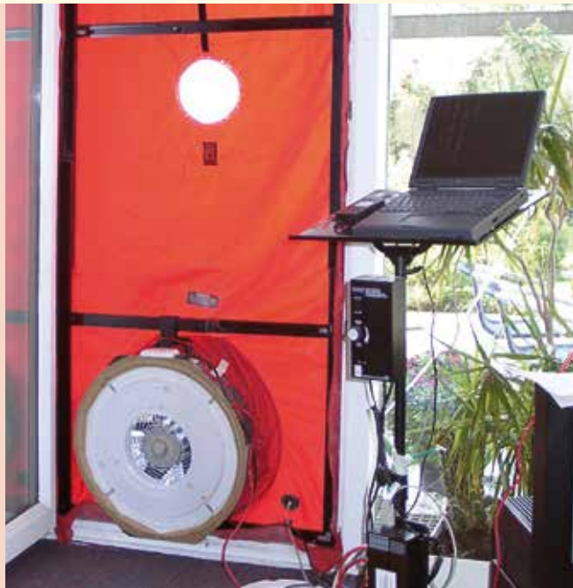
Ventilator zur Durchführung eines Drucktests
