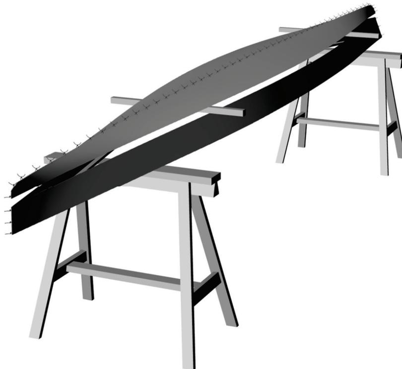
**Abbildung 32:** Seitenplanken und Bodenplanken werden so übereinandergelegt, dass das Boot kieloben liegt. Leisten sorgen für eine stabile Auflage der Bodenplanken.
