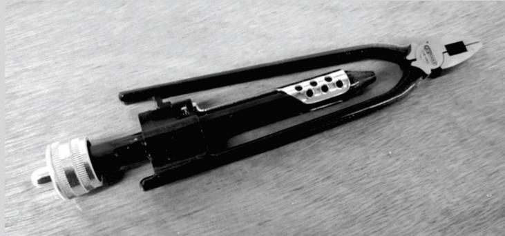
*Abbildung 30: Drahtwirbelzange.*
