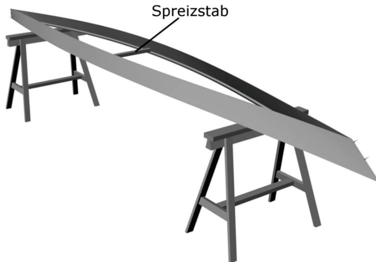
**Abbildung 31:** Die Seitenplanken sind nur an Bug- und Heckspitze miteinander verbunden und werden durch einen Stab auseinandergespreizt.
