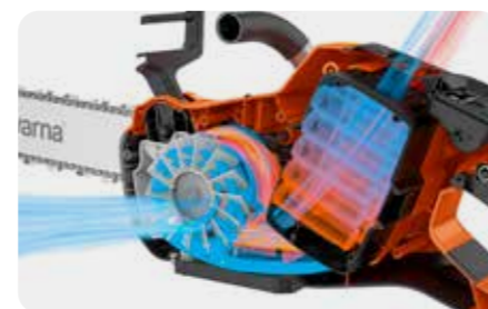
Die Akkus der Motorsägen werden bei Arbeitseinsätzen aktiv gekühlt, was für eine längere Lebensdauer der Akkus sorgt.
