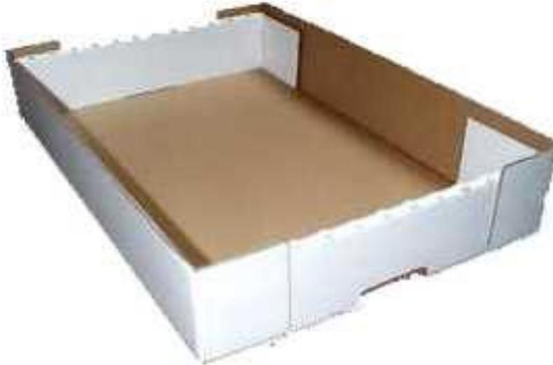
Wellpappkonstruktion aus BE Welle in konischer Ausführung mit doppelt eingefalteter konstruktiv verstärkter, kurzer Seitenlasche.
