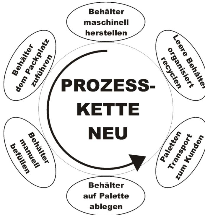
Der Wellpappbehälter wird als flacher Kartonzuschnitt auf Paletten angeliefert und auf einer Kartonaufrichtemaschine hergestellt.
