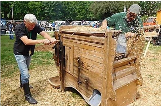
Handgetriebene Windfege zum Reinigen der Körner, die in die Schale links fallen
