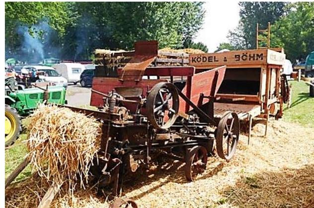
Lanzbulldogbetriebene mobile Dreschmaschinen mit separater Strohpresse
