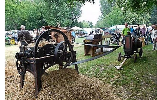
Strohschneidemaschine zum Zerschneiden von Stroh zu Siede
