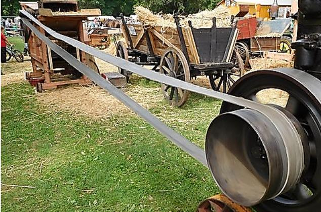
Standmotorgetriebener Hordenschüttler zum Abtrennen des Stroh von Körnern und Spreu
