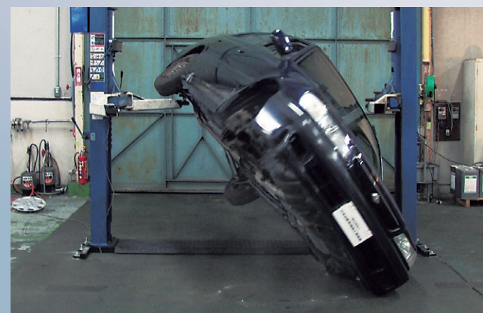
荷重バランスが悪い状況でのリフトアップによる車両落下検証実験写真
