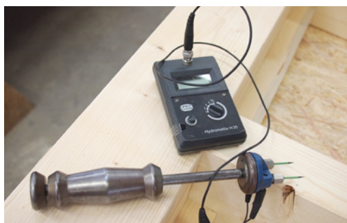
Abb. 14: Überprüfung der Holzfeuchte im Rahmen der Eigenüberwachung
