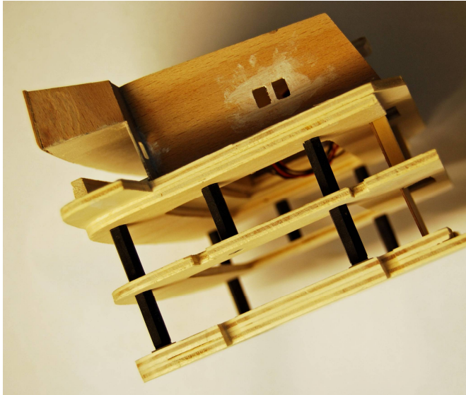
Bild 22: Decken der Decks mit Abstandshaltern
