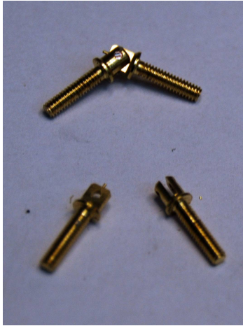
Bild 48: Scharnierschrauben zur Befestigung der Ladebäume Bild 49: Drehgelenke mit Führung für Luke 3
