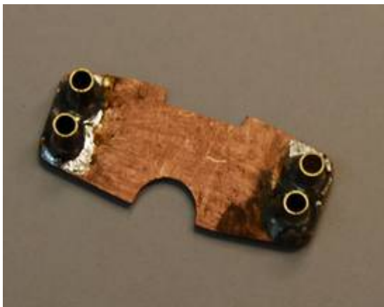
Bild 47: Untere Halterung für Ladebaum, 4 kleine Messing-Hohlbohrungen dienen als Drehlager
