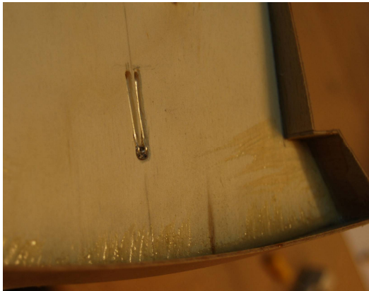
Bild 31: LED-Beleuchtung für Kommandobrücke
