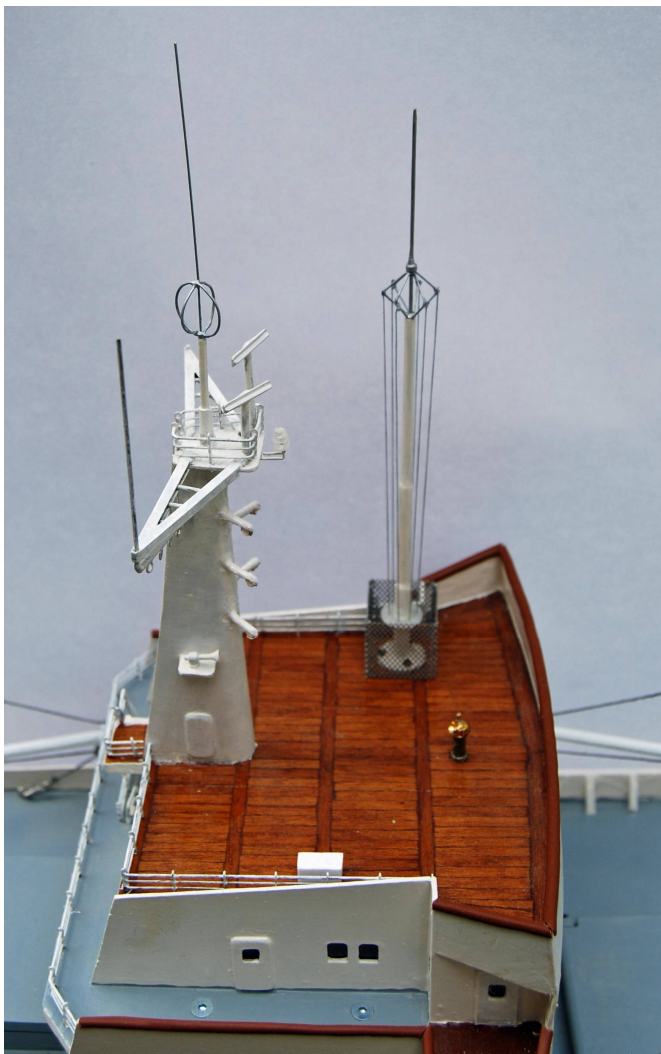
Bild 64: Peildeck mit Kompass und Sendemast im Faraday'schem Käfig
