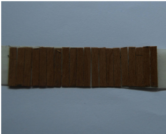
Bild 32: Furnierleisten auf Tesakrepp fixiert
