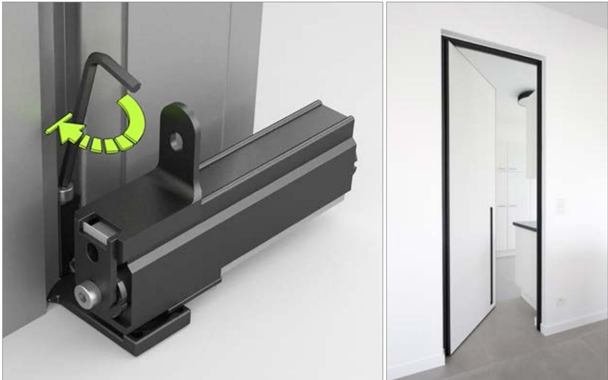
Die "Standard" -Scharniere sind für Türblätter mit einer Breite von bis zu 1100 mm ausgelegt. Diese Scharniere sind im Türrahmen montiert und haben daher keine Bodenbefestigung. Die Scharniere sind vollständig "unsichtbar" in das Türblatt integriert und bleiben sogar bei geöffneter Tür verborgen (im Gegensatz zu klassischen "unsichtbaren Scharnieren").
