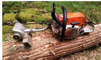
Abb. 6: Streifenweise motormanuelle Entrindung mit Motorsägenanbaugerät.
