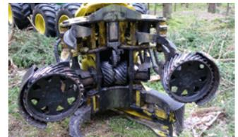
Abb. 8: Debarking Head an einem Harvester.
