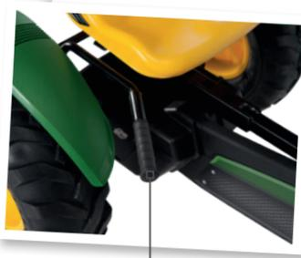
Mit Handbremse für zusätzliche Bremskraft.
