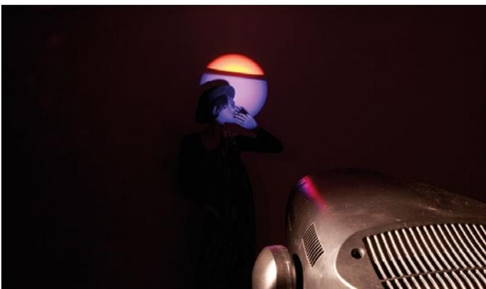
■ **Zoom und Fokus** so eingestellt, um Trennung der Halbfarbe scharf zu stellen (Pan/Tilt für Foto ebenso verstellt)
