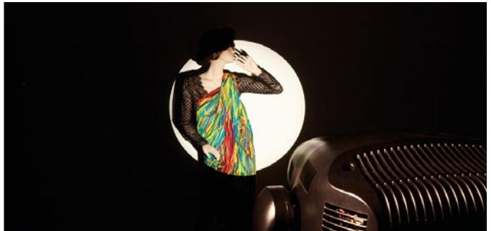
**Zoom bei scharfem Rand maximal eng gezogen** Projektionsabstand 3 m – bei einer normalen Projektionsentfernung von ca. 6 – 50 m wird der engste Infokus-Zoom erreicht, indem der Fokuswert auf 0 eingestellt und dann der Zoomkanal langsam von 0 angehoben wird. Je nach Entfernung erfolgt eine harte Fokussierung in den ersten 10% der Bewegung
