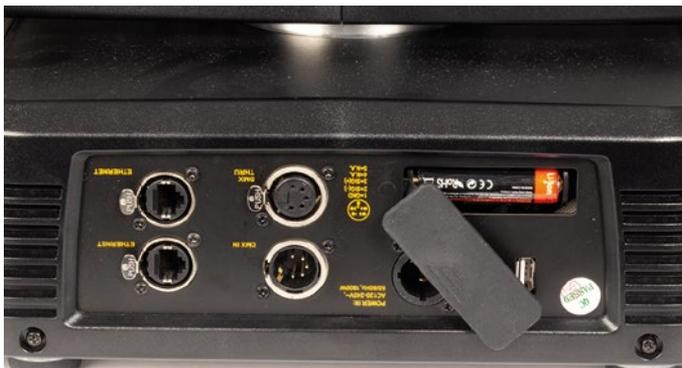
**Entfernbare Pufferbatterie** hinter einer angeschraubten Metallabdeckung (hier noch als Gummiabdeckung). Ethernet-Anschlüsse zum Durchschleifen (auch bei stromlosem Zustand), DMX und Stromverbinder und USB-Anschluss für Firmware
