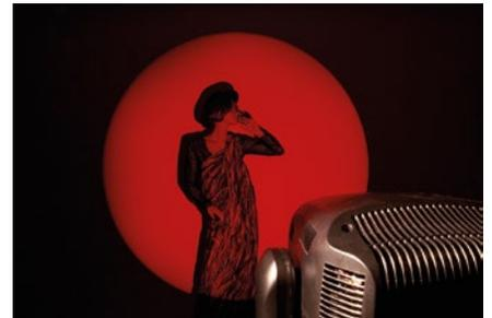
■ **RGB mit jeweils zwei Filtern** der CMY-Farbmischeinheit voll eingefahren (soweit hier druckbar)
