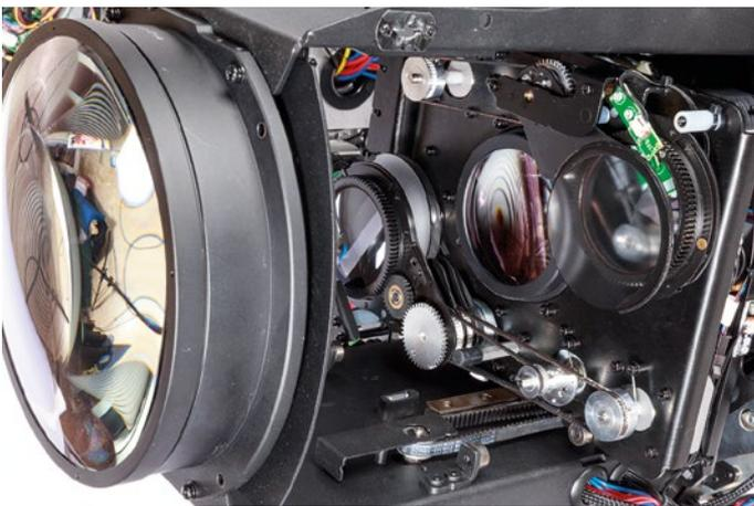
**Fokuslinsenschlitten mit zwei Achsen** Achse 1 mit mittlerem Frost und einem Fünffach-Rundprisma, Achse 2 mit leichtem und starkem Frost sowie einem Vierfach-Linearprisma
