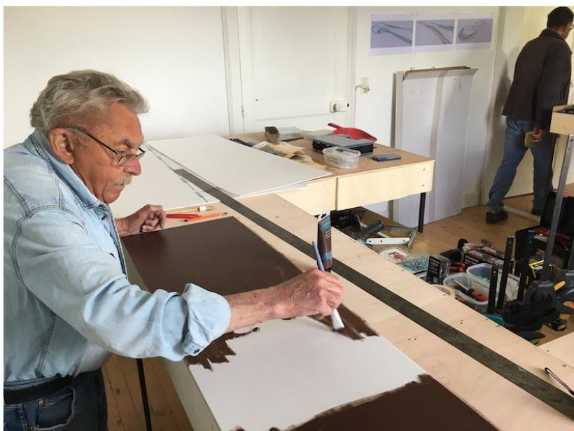
En suivant le plan conçu sur le logiciel *RailModeller Pro*, on pose provisoirement les aiguilles et les rails. Il s'agit d'une première approche destinée à vérifier si la position de ces dernières est juste. Un réajustement sera parfois nécessaire. Il faudra démonter pour mieux remonter !
