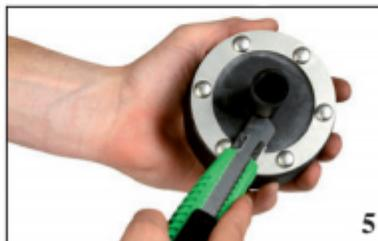
5 Mit einem Cutter den durchgeschobenen Ring einfach abschneiden
