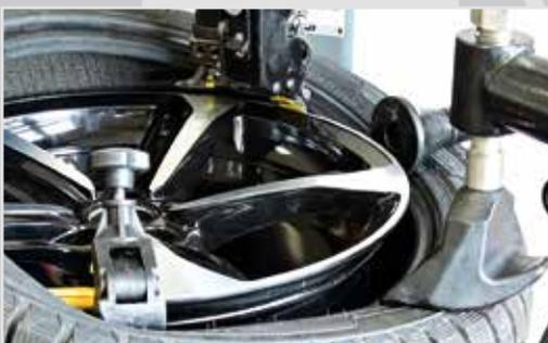
4. Beim Aufmontieren des Reifens auf die Felge ist darauf zu achten, dass alle drei Druckpunkte mit angemessenem Abstand angebracht werden. Es ist zudem sicherzustellen, dass der Kunststoff-Felgenschutz vor dem ersten Druckpunkt angebracht wird. Beim gesamten Vorgang und allen folgenden Schritten ist das Verwenden einer ausreichenden Menge an Reifenmontagepaste, zu berücksichtigen.
