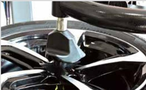
2. Beim Spannen von RF- und UHP-Reifen ist zu beachten, dass der Zentrierkonus genügend Druck ausübt. Dadurch wird die Felge, mittels der Spannbacken, gegriffen und sicher auf dem Teller fixiert. Dieser sollte entsprechend der Reifengröße vorpositioniert werden.
