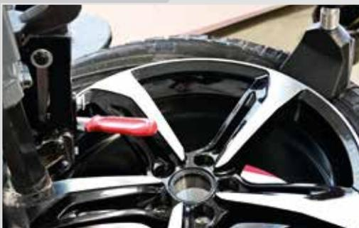
3. Verwenden Sie bei der Demontage des oberen Wulstes den Kunststoffhebel vor dem Montagekopf. Nutzen Sie den Hilfsarm, um den Reifen auf der gegenüberliegenden Seite leicht nach unten zu drücken und die Spannung am Wulst zu lösen. Stellen Sie sicher, dass der Reifenwulst in dem Felgenbett der Felge platziert ist. Halten Sie daraufhin den Kunststoffhebel fest und bewegen Sie den Drehteller langsam.
