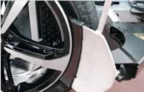
1. Achten Sie beim Abdrücken des Wulstes, eines RF- oder UHP-Reifens darauf, den Abstandshalter für die Reifenschaufel zu montieren. Bei allen Schritten der Montage und Demontage ist es wichtig, nicht zu kräftig auf die Seitenwand des Reifens zu drücken. Brechen Sie den Wulst nur auf, wenn sich das Ventil in einer h6- oder h12-Position befindet. Wird das Ventil beim Abdrücken des Wulstes in der falschen Position gehalten, kann es zu schweren Schäden am Gerät kommen.
