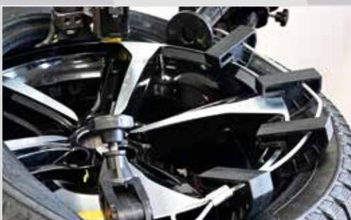
5. Bei der Felgenmontage besteht auch die Option, den Wulst-Niederhalter zu verwenden, um den Prozess zu erleichtern. Nutzen Sie den ersten Wulstdruckpunkt (Wulstrolle), um den Reifen unter dem Montagekopf in Position zu halten. Drehen Sie den Teller langsam und setzen Sie die Wulstdruckpunkte stückweise ein, nachdem die Druckpunktklemme und der Kunststoff-Felgenschutz platziert wurde.
