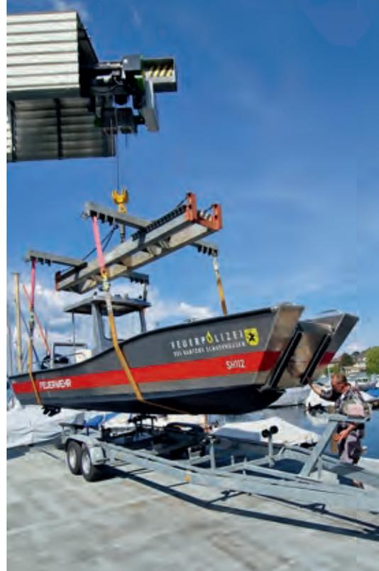
**Der Schiffskran hat eine Tragkraft von zirka 8 Tonnen.**
