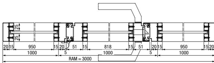
Horizontalschnitt 1-flügelige Stahl-Lofttür mit Seitenteilen und Oberlicht
