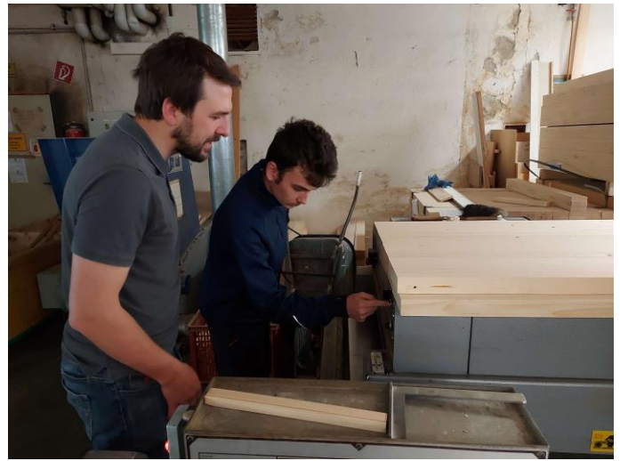
An der Formatkreissäge musste der Winkel für die Rückenlehnenneigung ausgerechnet werden.
