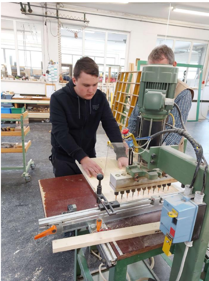
Eine praktische Maschine zur Bohrung der Regalbodeneinstellung.
