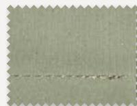
**TPU 420 DEN NYLON** (100% Polyamid). Extrem reiß- und abriebfestes Polyamid-Material, welches auf Grund der Beschichtungseigenschaften offenkantig verarbeitet werden kann.
