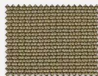
**T-Stretch** (100% Polyester). Das robuste, abriebfeste und hochelastische Material wird unter anderen bei Kleinteilen eingesetzt.
