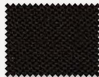
**420 HD NYLON** (100% Polyamid). Das klassische 420 den-Nylonmaterial bewährt sich in der „High Density“ (HD)-Ausführung als gutes Grundmaterial, welches flexibel eingesetzt werden kann. Durch den 420 den-Faden ergibt sich eine hohe Reißfestigkeit. Das Material ist durch dreifache PU-Beschichtung wasserundurchlässig ausgerüstet.
