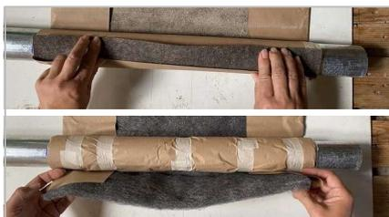
**19.** Weitere 6x abwechselnd Filz und Stahlwolle, wie bei Schritt 10. – 17., um das Rohr wickeln (siehe Laufzettel). *Enrouler 6 autres fois en alternance du feutre et de la laine d'acier autour du tube, comme aux étapes 10. - 17. Wrap another 6x alternately felt and steel wool, as in steps 10 - 17, around the pipe (see routing slip)*
