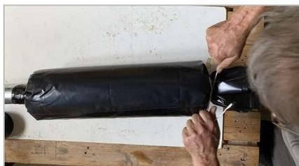
**28.** Obere Seite mit einem Band oder Kabelbinder fest verknotten und Schritte 25. – 27. wiederholen. *Nouer fermement la partie supérieure avec un ruban ou un serre-câble et répéter les étapes 25 à 27.*
