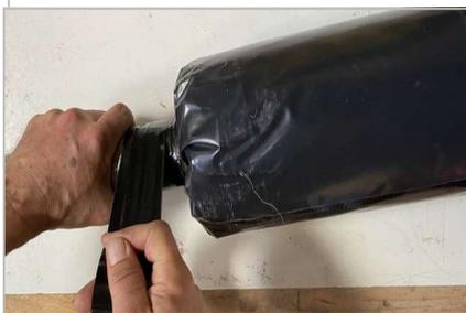
**27.** Untere Seite mit Gewebeband wasserdicht abkleben, sodass die offene Kante komplett überklebt ist. *Recouvrir le côté inférieur d'un ruban adhésif étanche à l'eau, de sorte que le bord ouvert soit complètement recouvert. Tape the underside with fabric tape so that it is waterproofed and the open edge is completely taped over*
