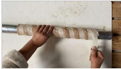
**17.** Papier mit 3x kurzen Klebestreifen fixieren und von links nach rechts das Klebeband an einem Stück spiralförmig fest um das Rohr kleben. Fixer le papier avec 3x bandes adhésives courtes et coller le ruban adhésif en spirale autour du tube de gauche à droite.
