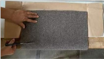
**10.** Papier aufklappen, Filz an Markierung anlegen und mit ca. 3 cm Überstand gerade abschneiden. *Déplier le papier, placer le feutre sur le repère et couper en ligne droite en laissant dépasser environ 3 cm.*
