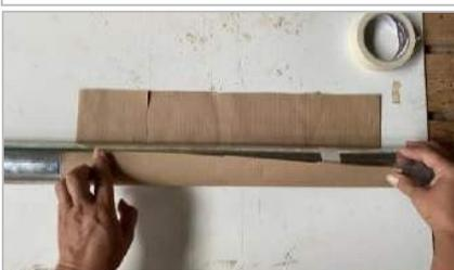
**7.** Untere Papierkante an 60 cm Markierung anlegen und Papier fest um das Rohr wickeln. *Placer le bord inférieur du papier sur la marque de 60 cm et enrouler fermement le papier autour du tube.*
