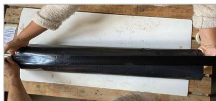
**23.** Folie auf derselben Stelle mit einem langen Streifen Gewebeband fixieren. *Fixer le film au même endroit avec une longue bande de ruban adhésif en tissu. Secure the foil in the same place with a long strip of fabric tape*
