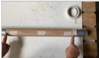
**8.** Papier mit Klebeband fixieren und beide Seiten am Rohr festkleben. *Fixer le papier avec du ruban adhésif et coller les deux côtés sur le tube.*
