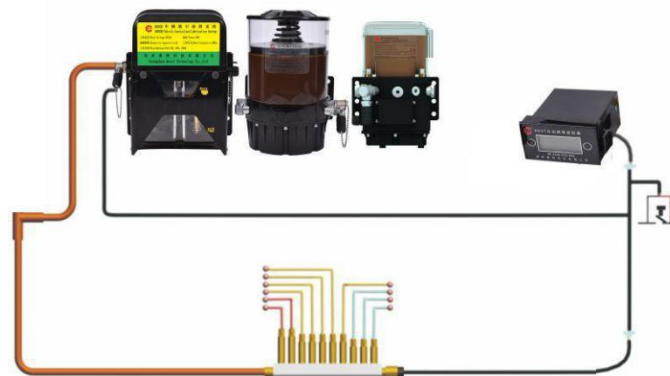
系统结构原理图 System Structure Diagram
