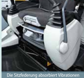
Die Sitzfederung absorbiert Vibrationen
