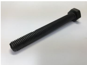
CFRTP製ボルト重量: 14.6グラム
