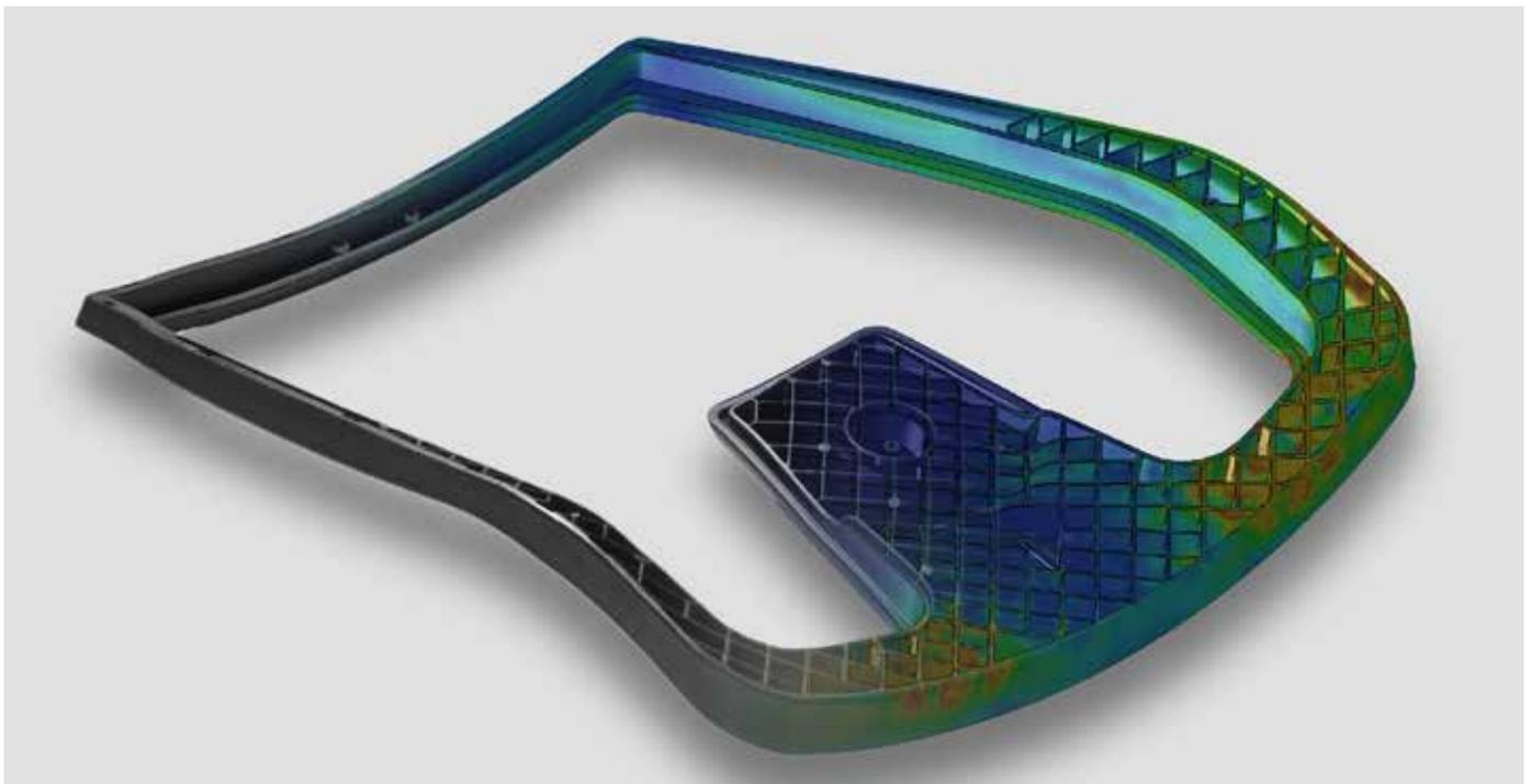
Belastungssimulation der Kunststoff-Rückenlehne (Berechnung nach der Finite-Elemente-Methode)
