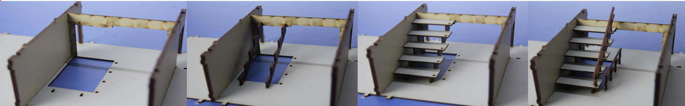
Badezimmereinbau: 1. Wand mit Tür einstecken 2. Waschbecken Stützen in den Boden einstecken 3. Waschbecken fixieren. 4. WC in Wand befestigen, 5. Wand hochklappen und befestigen 6. Inneres Seite der Aussenwand aufkleben.
