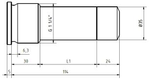
Rohrgewinde nach DIN ISO 228-1 Pipe thread according to DIN ISO 228-1
