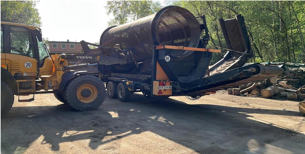
Sie erreicht bei einer Siebgröße von 20 mm je nach Materialtyp eine hohe Durchsatzleistung. Diese liegt typischerweise im Bereich von 50 bis 120 m<sup>3</sup> pro Stunde, abhängig von Faktoren wie:
