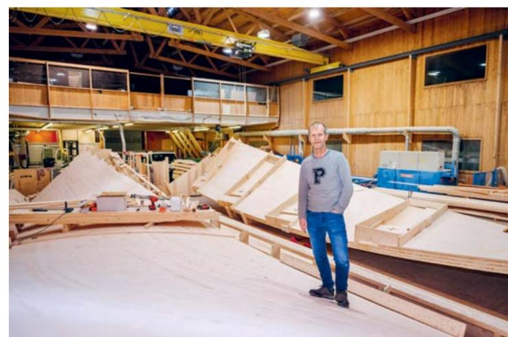
← Christoph Frommelt vor den 18 Meter langen und 4,5 Meter breiten Einzelementen, die in seiner Schaaner Zimmerei für den beeindruckenden Holzturm vorgefertigt worden sind.
