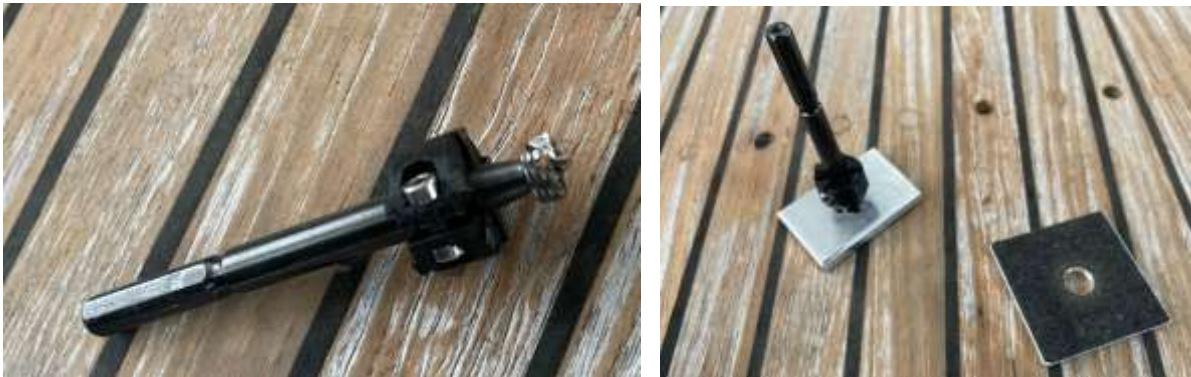
Bohrer mit Tiefenanschlag und Bohrschablone
