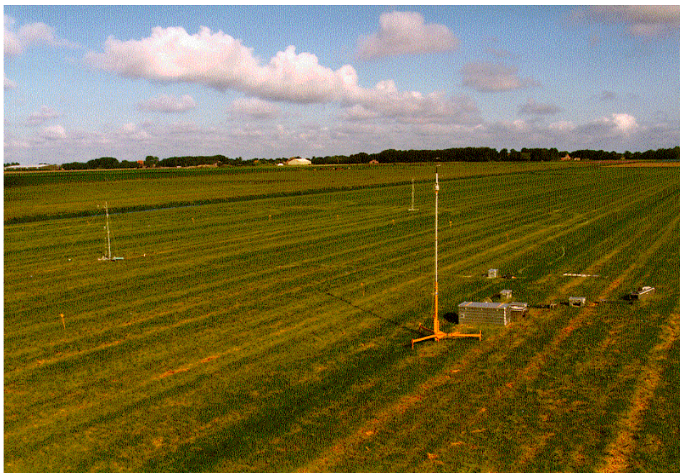
Figuur 6.6 Meetopstellingen voor het meten van ammoniakemissie na het aanwenden van mest op grasland
