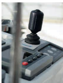
*Anlegen per Joystick. Das Boot vollzieht genau die Bewegungen, die der Rudergänger mit dem drehbaren Steuerhebel vorgibt*
