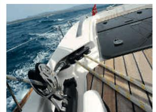
*Versteckt.* Schoten und Fallen laufen unter dem Aufbau durch. Das passt zum aufgeräumten Bild
