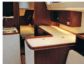
Umschlossen. Die Pantry ist in L-Form konzipiert. Der Spülblock mittschiffs ist auf See gut nutzbar
