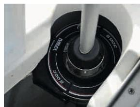
*Unsichtbar.* Die Rollanlage für die Genua wird unter Deck montiert. Gut für Optik und Leistung
