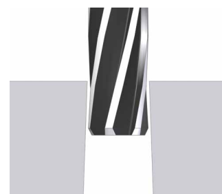
Konische Bohrung (Ende zu groß)
