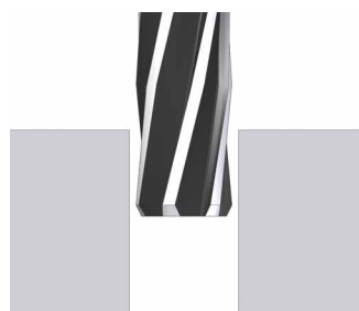
Bohrung wird zu groß
