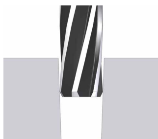
Konische Bohrung (Eingang zu groß)
