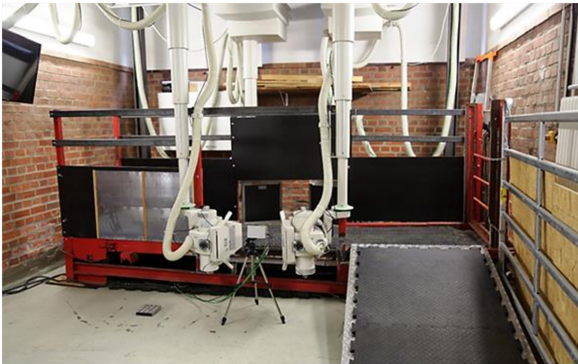
Abb. 2: Anlage für die Biplanare Fluoreszenzkinematografie (Fluokin) zur hochpräzisen Bewegungsanalyse. In 2023 wird ein neues 3D-FluoKin-System (3D-Röntgen-Fluoroskopie und Bewegungsanalyse System) eingebaut (DFG Großgerät)
