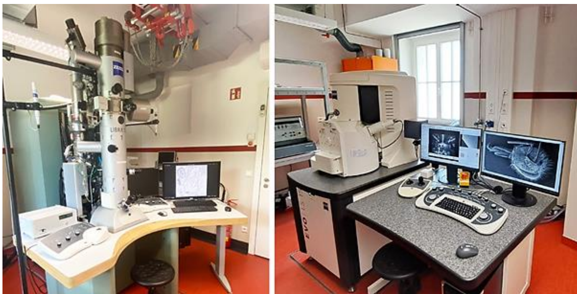
Abb. 3. Elektronenmikroskopisches Labor des Veterinär-Anatomischen Instituts mit dem Zeiss Libra 120 (links) und dem Zeiss EVO LS 15 (rechts)
