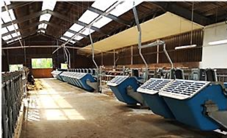
Wiegetröge zur Erfassung der Einzeltierfutterraufnahme im Milchviehstall
