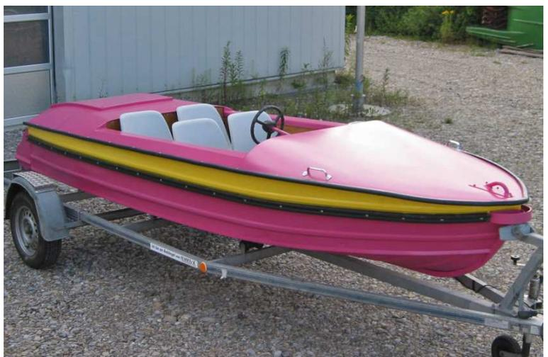
Alle Boote mit seitliche Auftriebskörpern, Innenverkleidung aus Bootsbausperholz. Rammschutzbügel im Burg, Scheuerleisten aus gleitfähigem HD-PE Kunststoff. Im Bug zwei seitliche Tragegriffe, großer Buggriff
