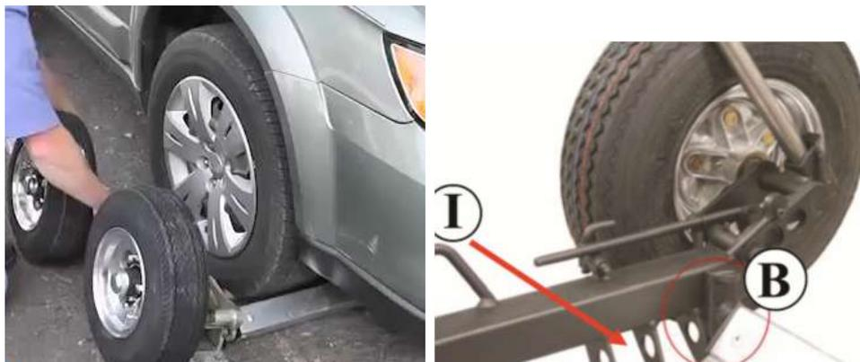
Fixez les extrémités des barres télescopiques (B) dans une des 3 "poches" (I) du Dolly (en fonction du diamètre des pneus). La poche choisie doit être la même des 2 côtés du véhicule.
