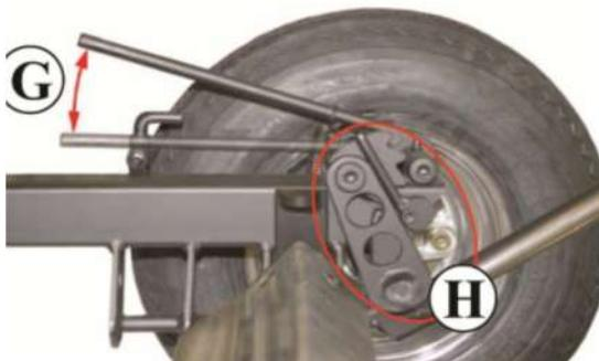
5. Soulever légèrement la barre de déplacement **(G)** de sorte à permettre à la fourche **(H)** de se dégager de celle-ci
