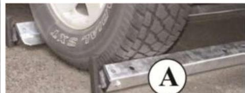
3. Soulevez le Dolly par la poignée et placez-le parallèlement aux roues du véhicule à remorquer. Les "poches" (I) doivent se trouver du côté du véhicule
