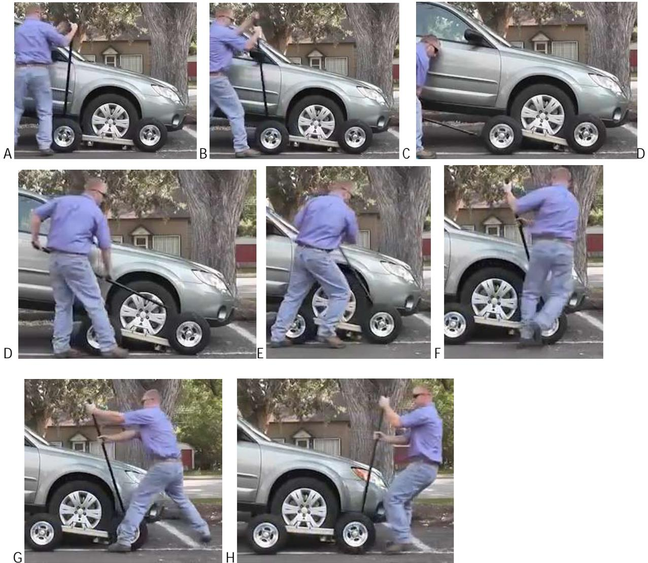
9. Une fois que les Dollies sont en position haute engagez les loquets de sécurité **(C)** en position fermée de sorte à bloquer les tiges d'ouverture **(G)** et à éviter que celle-ci ne se libèrent de leur emplacement lors du remorquage.
