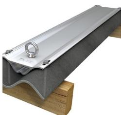
Aluminium Anschlageinrichtung mit Edelstahl-Ringöse zur fixen Montage. Spezielle Form für Welleternit-Dächer (Wellenabstand 177mm). Befestigung mit vier Edelstahlschrauben in zwei Sparren. Die 125cm lange Grundplatte wird bei Bedarf vor Ort auf den jeweiligen Sparrenabstand gekürzt. Inkl. Befestigungsmaterial.
