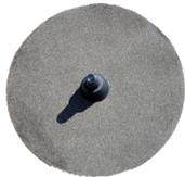
Abdichtmanschetten (Wurzelfest) für Anschlagpunkte, mit Beschleifung für Bitumendächer. Für Stützen Ø 16mm und Ø 42mm, inkl. Schrumpfschlauch.
