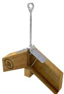
Edelstahl Anschlagpunkt (Ø16mm) für den Dachfirst, mit variabler Grundplatte. Kann von Hand an jede Dachneigung angepasst werden. Mit acht Edelstahlschrauben im Dachsparren befestigt. Inkl. Befestigungsmaterial.
