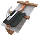
Edelstahl-Sicherheitsdachhaken für Ziegeldächer. Montage mit den 2 mitgelieferten Edelstahlschrauben durch die Konterlattung im Holzsparren. Unser Dachhaken kann entsprechend den Kriterien der DIN EN 62305-3 als natürlicher Bestandteil der Ableitung einer Blitzschutzanlage eingesetzt werden (100 kA) Inkl. Befestigungsmaterial.
